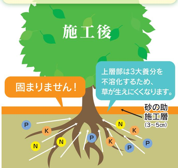
砂の助を施工するのは上層部の3~5センチ程度。
